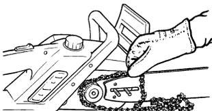
7. Tenez la barre-guide contre le corps de la tronçonneuse et installez la bride de la barre. Assurez-vous que la cheville de réglage est bien dans le trou de la barre qui lui est réservé.
