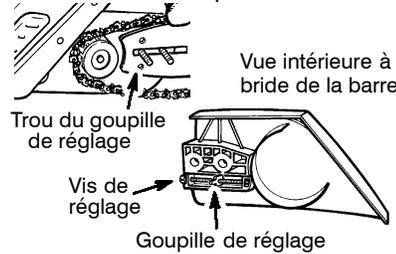
8. Fixez la barre-guide et la bride de la barre avec les écrous de bride de la barre. Ne les serrez qu'à la main.
