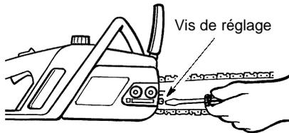
5. Vérifiez la tension en soulevant la chaîne. Si la chaîne est trop rigide, tirez-la vers le bas et laissez-la revenir en position plusieurs fois.
