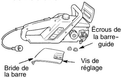
4. Tournez la vis de réglage dans le sens contraire de l'horloge pour déplacer la goupille de réglage aussi loin que possible vers l'arrière. N'enlevez pas la vis de réglage de la bride de la barre.
