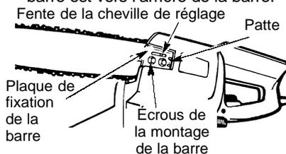
8. Fixez la barre-guide et la plaque de fixation de la barre avec les écrous de la barre. Ne les serrez qu'à la main.
