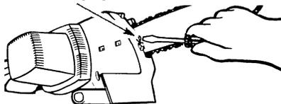
5. Vérifiez la tension en soulevant la chaîne. Si la chaîne est trop rigide, tirez-la vers le bas et laissez-la revenir en position plusieurs fois.
