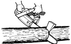
Arrêtez la tronçonneuse et utilisez un coin en plastique ou en bois pour ouvrir la coupe.
