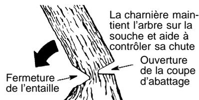
**REMARQUE:** Avant de terminer la coupe d'abattage, quand il faut contrôler la direction de la chute, utilisez des coins pour ouvrir la coupe. Pour éviter le recul et les dommages à la chaîne, utilisez des coins en bois ou en plastique, mais jamais en acier ni en fer.
