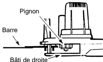
7. Tenez la barre-guide contre le corps de la tronçonneuse et installez la plaque de fixation de la barre. Assurez-vous que la cheville de réglage est bien dans le trou de la barre qui lui est réservé. Assurez-vous que la patte de la plaque de fixation de la barre est vers l'arrière de la barre.
