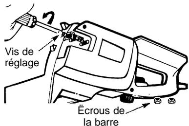
3. Enlevez les écrous de la barre, la plaque de fixation de la barre et l'ancienne chaîne.
