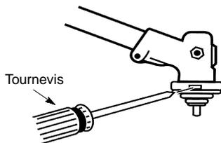
3. En maintenant le tournevis en position, enlevez la tête de coupe en tournant dans le sens des aiguilles d'une montre.
