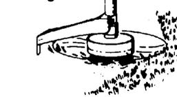
**BALAYAGE** - Vous pouvez utiliser l'action de balayage du fil de coupe pour nettoyer vite et facilement. Maintenez le fil parallèle aux surfaces balayées et au dessus d'elles et bougez l'appareil d'un côté à l'autre.
