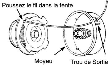
5. Embobinez le fil dans la bobine en maintenant sa tension et avec régularité. Embobinez dans la direction des flèche que vous trouverez sur la bobine.
