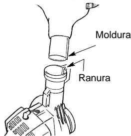
5. Introduzca el tubo en forma de codo en la salida de aire del propulsión. Asegúrese de que la moldura del tubo en forma de codo esté alineada con la ranura de salida de aire del propulsión.
