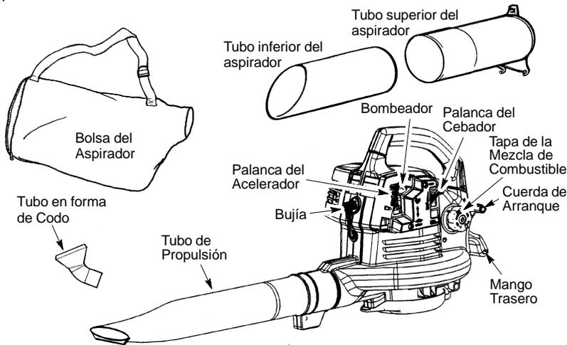
**PALANCA DEL ACELERADOR**
