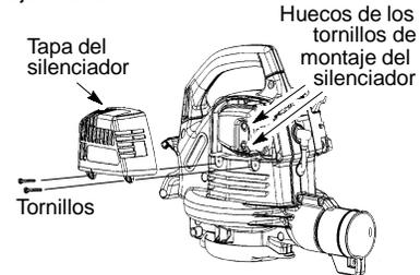
1. Afloje y retire los 2 tornillos de la tapa del silenciador.
