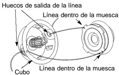
5. Enrolle la línea en la bobina de forma pareja y ajustada. Enrolle la línea en la dirección en que apuntan las flechas que se encuentran en la bobina.
