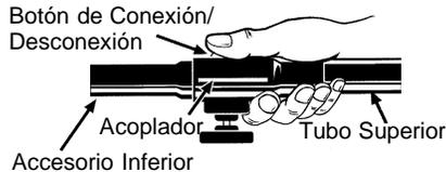
3. Mientras sostiene el motor y el tubo superior con firmeza, quite el accesorio inferior del acoplador en forma recta.
