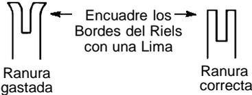
Cambie la barra si la ranura está gastada, si la barra está torcida o resquebrajada o si hay calentamiento excesivo o formación de protuberancias en los rieles. Si es necesario cambiar la barra, use exclusivamente la barra guía especificada para su sierra en la lista de repuestos, especificada también en la calcomanía de repuesto de barra y cadena que se encuentra en la sierra.
