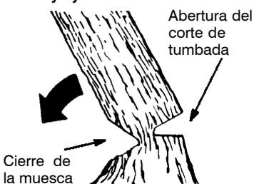
**AVISO:** Antes de completar el tumbado, use cuñas para abrir el corte, cuando sea necesario, para controlar la dirección de la caída. Use cuñas de madera o de plástico, pero nunca de acero o de hierro, para evitar que la sierra recule y para evitar daños a la cadena.
