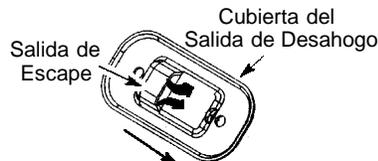
La salida de escape deberá estar colocada mirando hacia el freno de la cadena (del lado de la barra) de la sierra.
