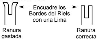
Cambie la barra si la ranura está gastada, si la barra está torcida o resquebrajada o si hay calentamiento excesivo o formación de protuberancias en los rieles. Si es necesario cambiar la barra, use exclusivamente la barra guía especificada para su sierra en la lista de repuestos, especificada también en la calcomanía de repuesto de barra y cadena que se encuentra en la sierra.
