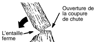
**REMARQUE:** Si le moteur pourrait sembler essayer de démarrer avant 5<sup>ème</sup> tirage, arrêtez tirant et procédez immédiatement à l'étape suivante. Avant d'achever la coupure de chute, employez des cales pour ouvrir la coupure si nécessaire afin de contrôler la direction de chute. Employez des cales en plastique ou en bois, mais jamais en acier ou en fer, afin d'éviter de recul et des dégâts à la chaîne.
