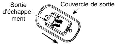
La sortie d'échappement doit faire face au frein de chaîne (côté du barre-guide) de la tronçonneuse.
