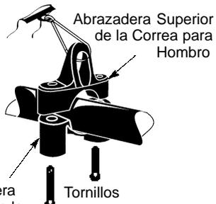
4. Inserte dos tornillos en los huecos para tornillos.
