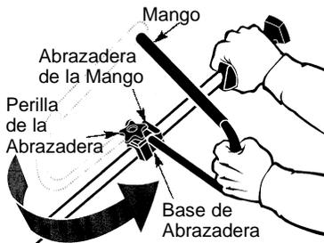
3. Coloque el mango en una posición de funcionamiento cómoda.
