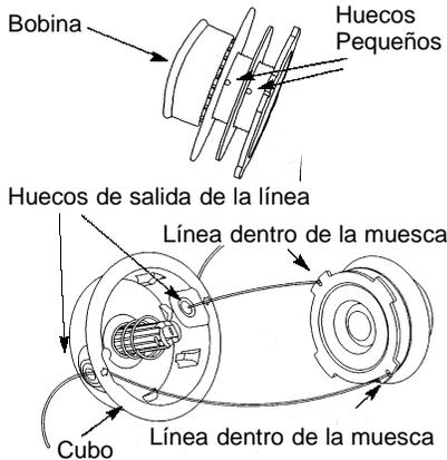
5. Enrolle la línea en la bobina de forma pareja y ajustada. Enrolle la línea en la dirección en que apuntan las flechas que se encuentran en la bobina.
