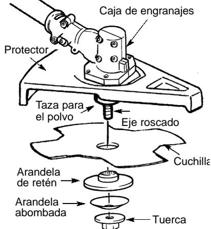
9. Manteniendo el destornillador en su posición, apriete firmemente la tuerca de la cuchilla con una llave.
