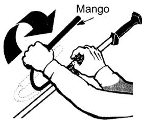
2. Haga rotar la mango/abrazadera a la izquierda hacia el motor hasta que la abrazadera cae en el ranura de la base de abrazadera.
