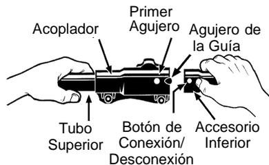
**ADVERTENCIA:** Antes de operar esta aparato, asegúrese de que el botón de conexión/desconexión esté asegurado en el primer agujero y la perilla esté bien ajustada. Todos los accesorios han sido diseñados para ser utilizados en el primer agujero. Para las accesorios opcional, vea la sección MONTAJE de la aplicables manual de instrucciones de la accesorio.
