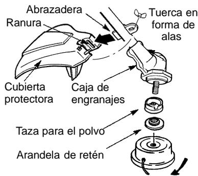
**AVISO:** Antes de instalar el cabezal de corte, asegúrese de que todos los componentes estén instalados correctamente según aparecen en la ilustración.
