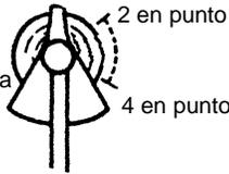
Corte utilizando la sección de la cuchilla correspondiente a la franja horaria entre las 2 y las 4.
