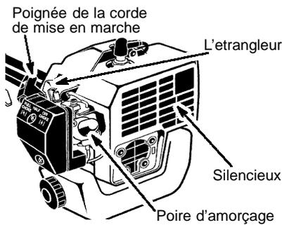
**REMARQUE:** Si le moteur ne part pas, tirez le corde de mise en marche encore 5 fois. Si le moteur ne démarre toujours pas, c'est qu'il est probablement noyé.
