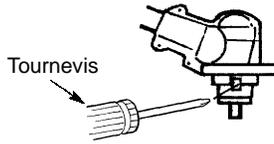
3. En maintenant le tournevis en position, enlevez la tête de coupe en tournant dans le sens des aiguilles d'une montre.
