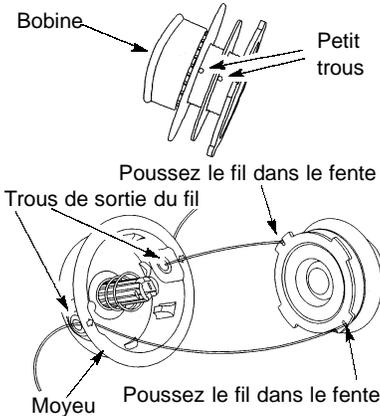
5. Embobinez le fil dans la bobine en maintenant sa tension et avec régularité. Embobinez dans la direction des flèches que vous trouverez sur la bobine.
