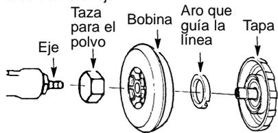
Utilice una bobina previamente enrollada o vuelva a enrollar línea nueva en la bobina existente. Si utiliza una bobina pre-enrollada, retire la tira adhesiva de la línea y la bobina.
