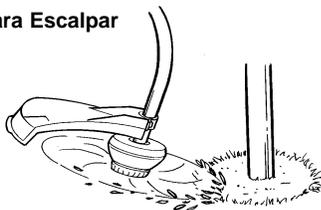
**PARA CORTAR CÉSPED** - Este aparato es ideal para cortar césped en lugares donde las cortadoras convencionales no llegan. En posición de cortar césped, mantenga la línea paralela al suelo. Evite presionar el cabezal contra el suelo, ya que de hacerlo podría escalar la vegetación y dañar el aparato.
