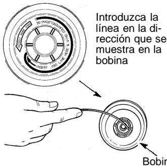
Introduzca la línea en la dirección que se muestra en la bobina
