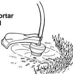
**PARA BARRER** - Se puede usar la acción ventiladora de la línea girante para barrer rápida y fácilmente un área determinada. Mantenga la línea paralela al suelo directamente encima de las superficies que se quiera barrer y mueva el aparato de un lado al otro rápidamente.
