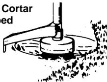
**PARA BARRER** - Se puede usar la acción ventiladora de la línea girante para barrer rápida y fácilmente un área determinada. Mantenga la línea paralela al suelo directamente encima de las superficies que se quiera barrer y meuva el aparato de un lado al otro rápidamente.
