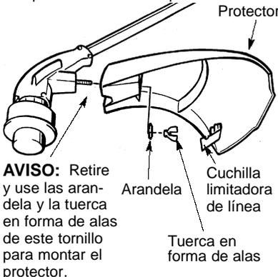
**AVISO:** Retire y use las arandela y la tuerca en forma de alas de este tornillo para montar el protector.
