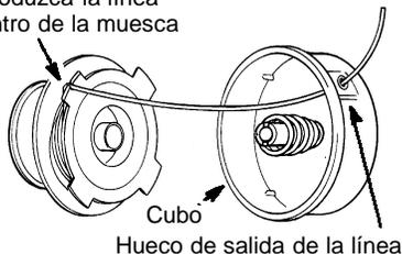
5. Enrolle la línea en la bobina de forma pareja y ajustada. Enrolle la línea en la dirección en que apuntan las flecha que se encuentran en la bobina.
