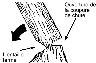
**REMARQUE:** Avant d'achever la coupure de chute, employez des cales pour ouvrir la coupure si nécessaire afin de contrôler la direction de chute. Employez des cales en plastique ou en bois, mais
