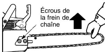
On fait le réglage en desserrant les écrous de la barre et en faisant tourner la vis de réglage 90° pendant qu'on hausse la barre.
