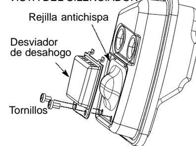
Cambie la rejilla antichispa cada 50 horas de la operación o si observa algún daño o roturas en la rejilla.
