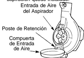
5. Coloque los ganchos que se encuentran en el tubo de aspiración en el poste de retención; gire el tubo hasta quedar en posición. Asegure el tubo de aspiración girando la perilla hacia la derecha hasta quedar ajustado.
