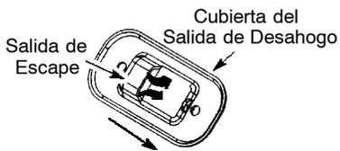
La salida de escape deberá estar colocada mirando hacia el freno de la cadena (del lado de la barra) de la sierra.
