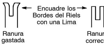
Cambie la barra si la ranura está gastada, si la barra está torcida o resquebrajada o si hay calentamiento excesivo o formación de protuberancias en los rieles. Si es necesario cambiar la barra, use exclusivamente la barra guía especificada para su sierra en la lista de repuestos, especificada también en la calcomanía de repuesto de barra y cadena que se encuentra en la sierra.
