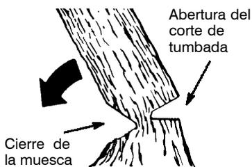
**AVISO:** Antes de completar el tumbado, use cuñas para abrir el corte, cuando sea necesario, para controlar la dirección de la caída. Use cuñas de madera o de plástico, pero nunca de acero o de hierro, para evitar que la sierra recule y para evitar daños a la cadena.
