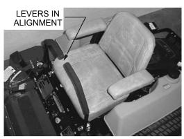
FIGURE 2 LEVER ALIGNMENT
