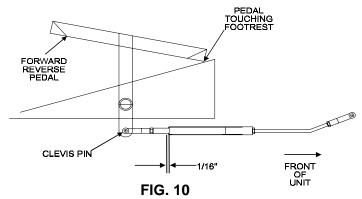
MOTION CONTROL LINKAGE ADJUSTMENT
