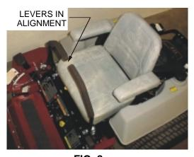
FIG. 2 LEVER ALIGNMENT
