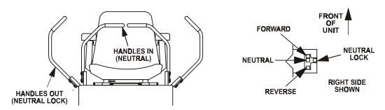
FIG. 3 MOTION CONTROL POSITIONS
