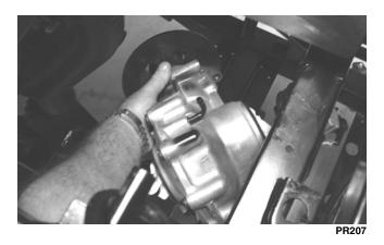
**REAR DRIVE INPUT SHAFT/** HOUSING
