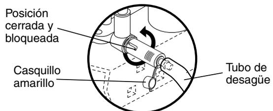
3. Abra la válvula de desagüe empujando hacia dentro y dando vuelta a la izquierda.
