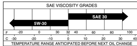
**AVISO:** A pesar de que los aceites de multiviscosidad (5W30, 10W30, etc.) mejoran el arranque en clima frío, estos aceites de multiviscosidad van a aumentar el consumo de aceite cuando se usan en temperaturas sobre 32° F (0° C). Revise el nivel del aceite del motor más a menudo, para evitar un posible daño en el motor, debido a que no tiene suficiente aceite.
