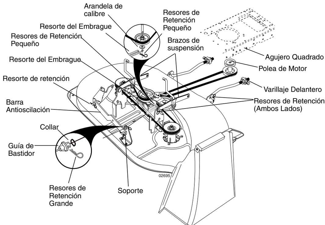
7. Empuje la guía de la cubierta del cable del embrague en el soporte, deslice el collar sobre la guía y asegúrela con el resorte grande de retención.
