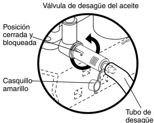
3. Abra la válvula de desagüe empujando hacia dentro y dando vuelta a la izquierda.
