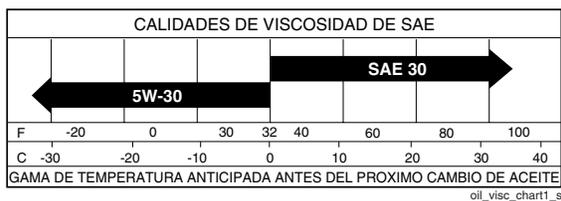
**AVISO:** A pesar de que los aceites de multiviscosidad (5W30, 10W30, etc.) mejoran el arranque en clima frío, estos aceites de multiviscosidad van a aumentar el consumo de aceite cuando se usan en temperaturas sobre 32° F (0° C). Revise el nivel del aceite del motor más a menudo, para evitar un posible daño en el motor, debido a que no tiene suficiente aceite. Cambie el aceite después de 25 horas de operación o por lo menos una vez al año si el tractor se utiliza menos 25 horas el año.
