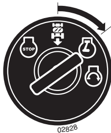
POSITION DE MOTEUR ON
