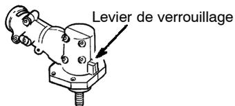
9. Continuez à tenir en place le levier de verrouillage. Cela empêchera l'arbre de tourner pendant que vous resserez l'écrou de la lame.
