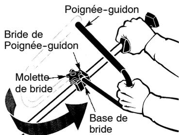
3. Placez le poignée-guidon dans une position confortable de l'utilisation.
