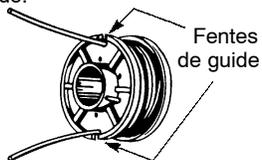
8. Insérez le bouts du fil dans les trous de sortie situé sur le tête de coupe.
