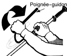
2. Tournez poignée-guidon/bride dans le sens contraire des aiguilles d'une montre vers le moteur jusqu'à ce que la bride tombe dans la rainure de la base.
