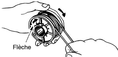
7. Avec votre doigt entre les fils, enroulez le fil bien serré et uniformément sur la bobine, dans le sens de la flèche de la bobine. Placez les fils dans les fentes de guide.
