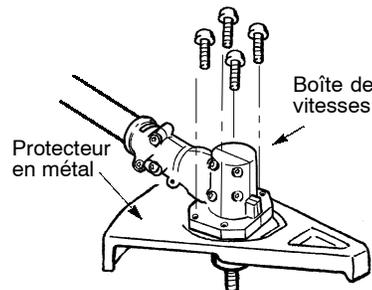
2. Insérez et vissez les 4 vis de montage à travers les trous de la boîte de vitesses et la protecteur en métal. Serrez-les à fond avec l'une des clés hexagonales fournies.
