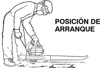
**ADVERTENCIA:** A arrancar el motor, sostenga el aparato como se ilustra en la figura. Apoye el aparato exclusivamente en una superficie limpia y sólida siempre que vaya a efectuar el arranque y siempre que tenga que apoyar el aparato con el motor en marcha. Los escombros tales como la gravilla, la arena, la tierra, el césped, etc. pueden ser succionados por la entrada de aire y arrojados por la abertura de objetos o causando graves heridas a espectadores o al usuario.
