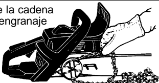
Dirección correcta de la cadena
