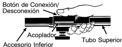
3. Mientras sostiene el tubo superior con firmeza, quite el accesorio inferior del acoplador en forma recta.
