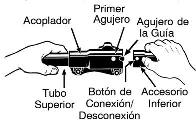
3. Empuje el accesorio inferior en el acoplador hasta que el botón de conexión/desconexión se encaje en el primer agujero.
