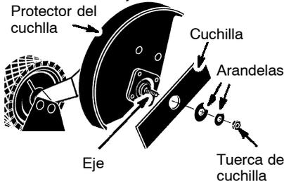
5. Coloque la cuchilla nueva en el eje.
