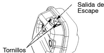
Cambie la rejilla antichispa cada 25 horas de la operación o si observa algún daño o roturas en la rejilla.
