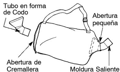
**AVISO:** Asegúrese de que el borde de la abertura pequeña de la bolsa de encuentre pegado a la parte en forma de embudo del tubo en forma de codo, y la moldura saliente del tubo en forma de codo se encuentre al fondo.
