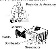
**ADVERTENCIA:** El cabezal de corte se moverá cuando comienze a encender el motor de su unidad. Cuando el silenciador se encuentra caliente puede causar graves
