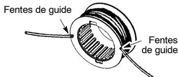
9. Insérez les bouts du fil dans le trous de sortie situé sur la couvercle.
