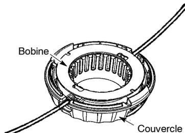
11. Assurez-vous que les fils ne sont pas attrapés entre le bord du bobine et du mur de la couvercle.
