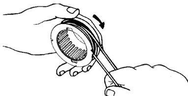
7. Avec votre doigt entre les fils, enroulez le fil bien serré et uniformément sur la bobine, dans un sens horaire.
