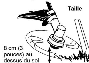
**RASAGE** - La technique de rasage retire toute végétation non désirée. Maintenez le bas de la tête de coupe à environ 8 cm (3 pouces) du sol et à un angle. Permettez à la pointe du fil de frapper le sol autour des arbres, des piquets, des monuments, etc. Avec cette technique, le fil s'use plus vite.
