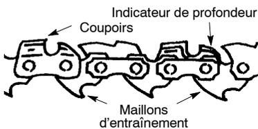
6. Placez la chaîne dans le pignon situé derrière le retenue de l'embrayage. Mettez la chaîne entre les dents du pignon.
