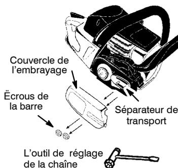
3. Tournez la vis de réglage sur la chaîne pour amener le mécanisme de réglage aussi loin que possible vers l'avant du guide-chaîne.
