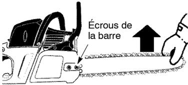
**AVERTISSEMENT:** Si le tronçonneuse est fonctionné avec une chaîne lâche, la chaîne pourrait sauter de la barre et resulter en de blessures graves.
