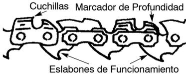
6. Coloque la cadena por encima y detrás del seguidor del embrague, ponga los eslabones de funcionamiento en el cilindro del embrague.
