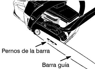
5. Retire muy cuidadosamente la cadena del paquete. Sostenga la cadena con los eslabones de impulsión orientados como se ve en la ilustración.
