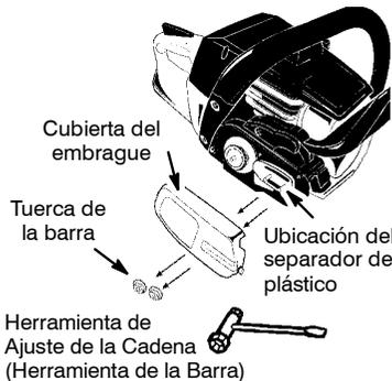
3. Gire el tornillo de ajuste en la barra para mover el piñón de tensión tan lejos como se posible en dirección hacia la parte delantera de la barra.
