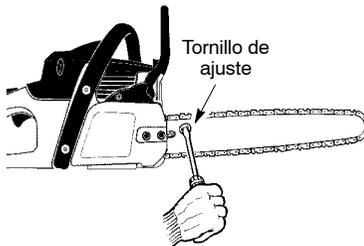
3. Usando la herramienta de la barra, haga girar la cadena alrededor de la barra guía para asegurarse de que todos los eslabones se encuentren dentro de las ranura de la barra.
