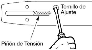
4. Haga deslizar la barra en los pernos de la barra hasta que la barra se detenga al tocar el engranaje del cilindro del embrague.
