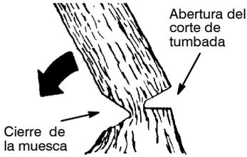
**AVISO:** Antes de completar el tumbado, use cuñas para abrir el corte, cuando sea necesario, para controlar la dirección de la caída. Use cuñas de madera o de plástico, pero nunca de acero o de hierro, para evitar que la sierra recule y para evitar daños a la cadena.
