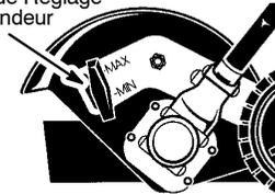
1. Desserrez le molette de réglage de profondeur.
