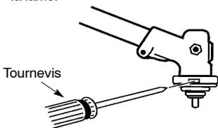
3. En maintenant le tournevis en position, enlevez l'écrou de la lame en tournant dans le sens des aiguilles d'une montre.
