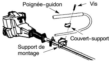
1. Placez le support de montage sur l'axe supérieur au-dessus de la flèche sur l'étiquette de sécurité. Assurez-vous d'utiliser le correct support de montage pour le tube supérieur de diamètre de 2,5 cm (1 pouce) ou de 2,2 cm (7/8 pouce).
