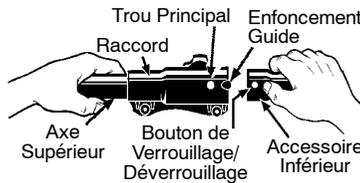
3. Poussez l'accessoire dans le record jusqu'à ce que le bouton de verrouillage/déverrouillage soit bien fixé dans le trou principal.
