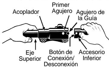
**ADVERTENCIA:** Antes de operar esta aparato, asegúrese de que el botón de conexión/desconexión esté asegurado en el primer agujero y la perilla esté bien ajustada. Todos los accesorios han sido diseñados para ser utilizados en el primer agujero.
