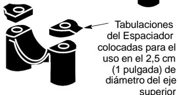
1. Coloque la abrazadera superior de la correa para hombro en la parte superior sobre la mango.
