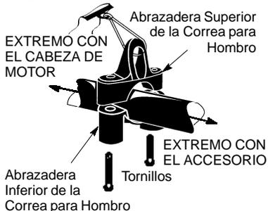
3. Inserte dos tornillos en los huecos para tornillo.
