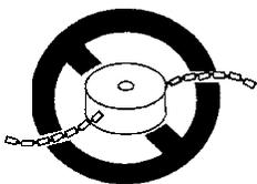
**⚠ ADVERTENCIA:** La cuchilla sigue girando incluso después de soltar el acelerador o de apagar el motor. Incluso cuando está girando libremente, la cuchilla puede despedir objetos o causar cortes profundos si se toca accidentalmente. Detenga la cuchilla poniendo en contacto el lado derecho de la misma con material ya cortado.
