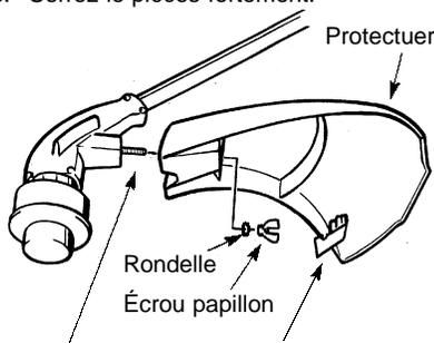
**REMARQUE:** Enlevez les rondelle et les écrou papillon de ce boulon et utilisez-les pour monter le protecteur.
