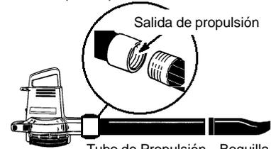
Para el Modelo 2695 únicamente, el tubo de extensión del propulsor y la boquilla están combinados en una sola pieza.
