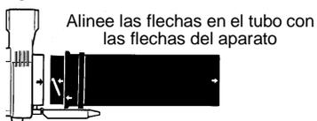
4. Introduzca el tubo de la aspiradora inferior al tubo de la aspiradora superior por primero alineando las flechas en ambos tubos. Luego, presione juntos ambos tubos hasta que el tubo inferior ajustes firmemente en el tubo superior (alrededor de 3 pulgadas).
