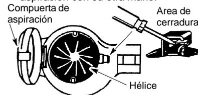
3. Gire el limitador de entrada de aire hacia la izquierda (en sentido contrario al de las agujas del reloj), y despéguelo del aparato. No cierre la compuerta de aspiración. Usted entonces introducirá los tubos de la aspiradora.
