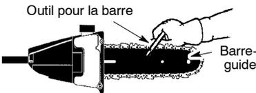
2. Desserrez les écrou de bride de la barre jusqu'à ce qu'ils ne soient pas plus serrés contre le bride qu'on peut le faire des doigts.
