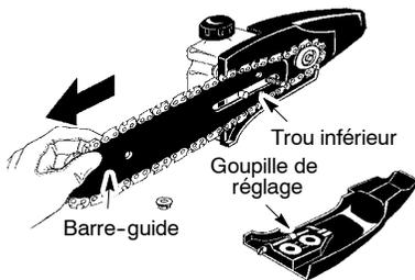
13. Installez les écrou de bride de la barre et ne les serrez que des doigts. Ne les serrez pas plus à ce point-ci. Procédez au RÉGLAGE DE LA CHAÎNE.
