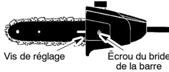
3. Tournez la vis de réglage dans le sens de l'horloge jusqu'à ce que la chaîne touche à peine au bas de la barre.
