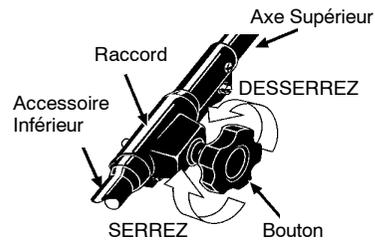
2. Appuyez sur le bouton de verrouillage/déverrouillage et maintenez-le appuyé.
