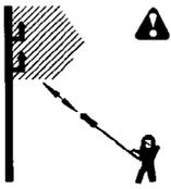
**⚠ DANGER:** N'utilisez pas près des fils de puissance électriques ou des lignes de puissance électriques. Gardez le taille buisson au moins 10 mètres (30 pieds) de toutes les lignes de puissance électriques.
