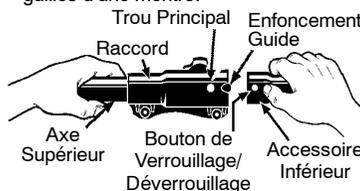
**⚠ AVERTISSEMENT:** Assurez-vous que le bouton de verrouillage/déverrouillage soit bien fixé dans le trou principal et que le bouton soit bien fixé avant de faire fonctionner votre appareil. Tous les accessoires sont conçus pour être utilisés dans le trou principal.
