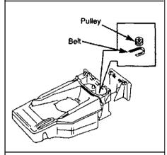
REMOVE THE 'C' CLIP AND THE PULLEY FROM THE GEARBOX SHAFT.
