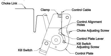
FIGURE 2 15 HP KOHLER SPEED CONTROL (THROTTLE CABLE HOOK-UP)
