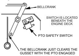
FIGURE 13 BLADE ENGAGEMENT LINKAGE
